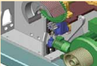
Rotation lente assurée par un motoréducteur
